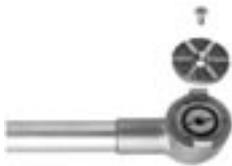
die Befestigungsschraube mit dem mitgelieferten Schraubendreher lösen und herausnehmen. Vorsichtig die Scheibe abheben. Dabei darauf achten das die zwei Pufferfedern nicht aus den Führungen rutschen. (Die Federn haben die Aufgabe die Schleifscheibe beim Wechsel, für leichteres Entnehmen, etwas anzuheben) Die Auflagefläche mit einer weichen Bürste reinigen. Zusammenbau in umgekehrter Reihenfolge.
