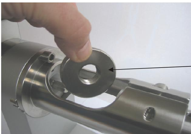
Sicherungsmutter (5) in einer ca. 45° Stellung zur Schneidtrommel in die Montageöffnung einsetzen.
