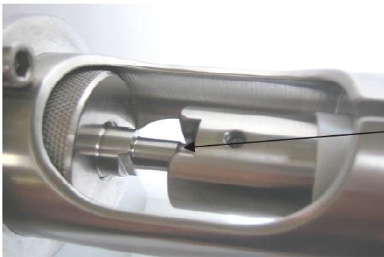
Die Handkurbel (3) mit der Schneidtrommelachse zusammenpassen. Dabei auf die Zusammenführung der Nuten achten.
