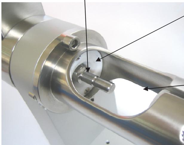
Lager der Schneidtrommelachse
